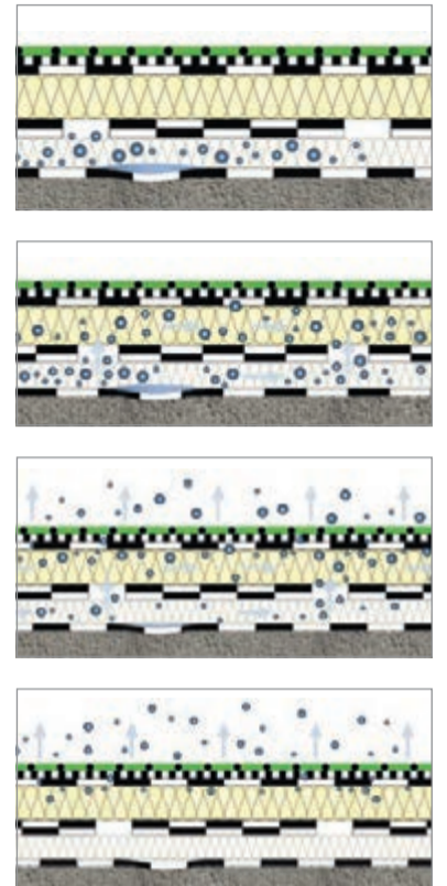
... der Prozess der Austrocknung: Ohne weiteres Dazutun diffundiert vorhandene Feuchtigkeit nach und nach durch die diffusionsoffene Abdichtungslage.
