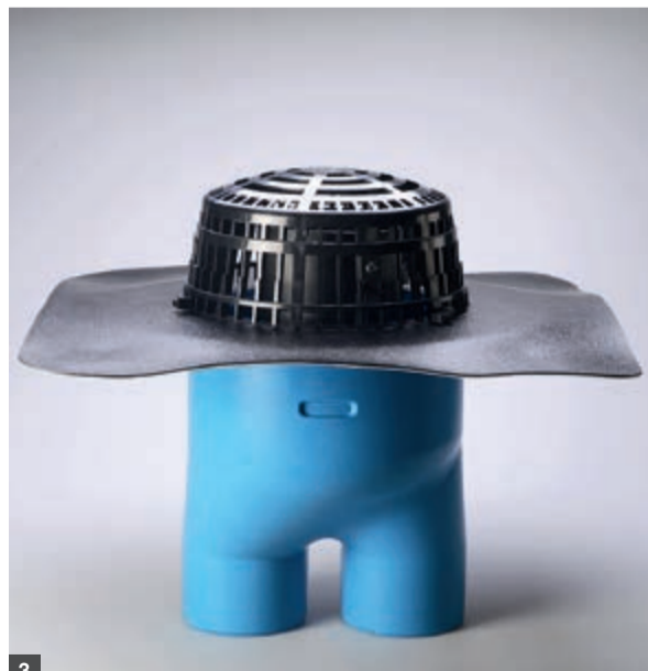
Abbildung 3: Kombi-Gully II für die gleichzeitige Hauptentwässerung und Notentwässerung in DN 100. Das eingesteckte Notentwässerungsrohr ist passend gekürzt und kann unter dem Kiesfangkorb vor Verunreinigungen geschützt werden.
