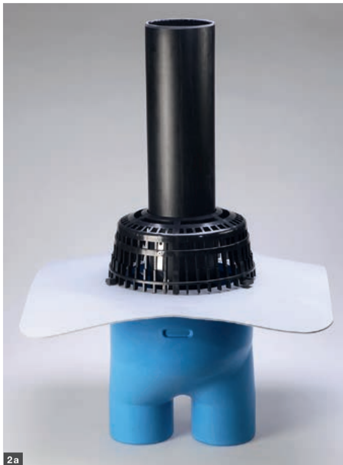
Abbildung 2: Kombi-Gully I für die gleichzeitige Entwässerung und Entlüftung in DN 100. Mit passend ausgespartem Kiesfangkorb (a) und einer getrennten und wasserdichten Leitungsführung im Inneren des Ablaufs (b).
