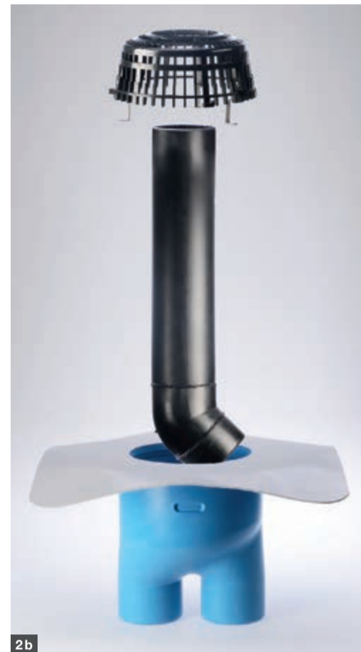
Abbildung 2: Kombi-Gully I für die gleichzeitige Entwässerung und Entlüftung in DN 100. Mit passend ausgespartem Kiesfangkorb (a) und einer getrennten und wasserdichten Leitungsführung im Inneren des Ablaufs (b).
