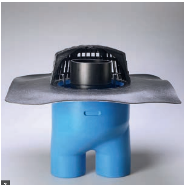
Abbildung 3: Kombi-Gully II für die gleichzeitige Hauptentwässerung und Notentwässerung in DN 100. Das eingesteckte Notentwässerungsrohr ist passend gekürzt und kann unter dem Kiesfangkorb vor Verunreinigungen geschützt werden.
